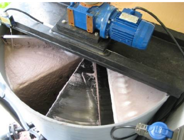
Flottateur PUROSTAR Ø1m Application : Agro-alimentaire Débit = 0,5m 3 /h Rendement = 94%
